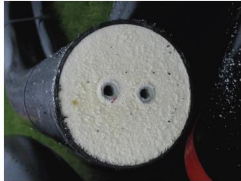
Figur 12 Tværsnit af det fremstillede prototypesør 14/14/110 mm
